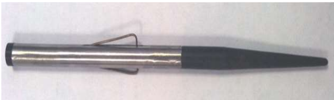
Рис. 2. Конусная пробка-стержень с пружинным фиксатором для закрытия трубки истечения вискозиметра ВУ-М-ПХП
