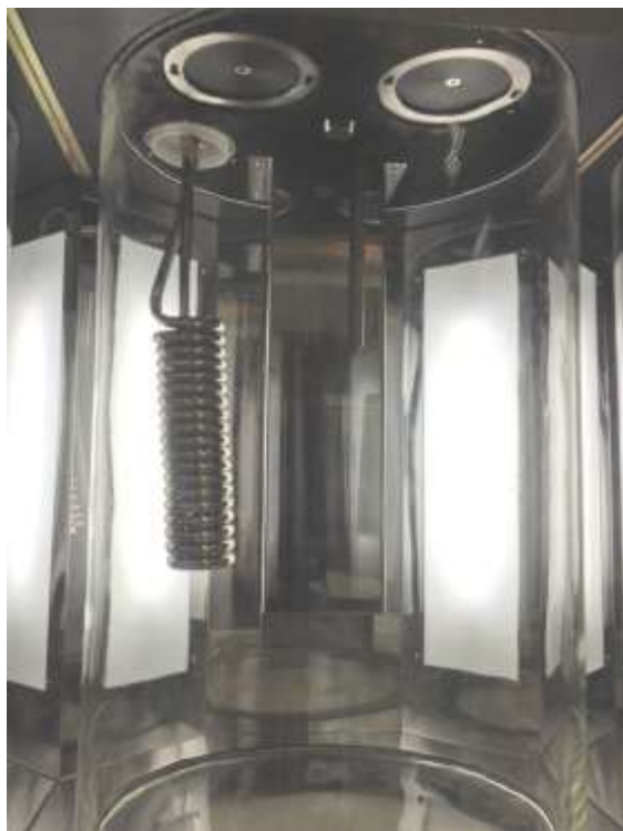
Рис. 6 Расположение спирали компрессора охлаждения в ванне термостата КВПД-ПХП
