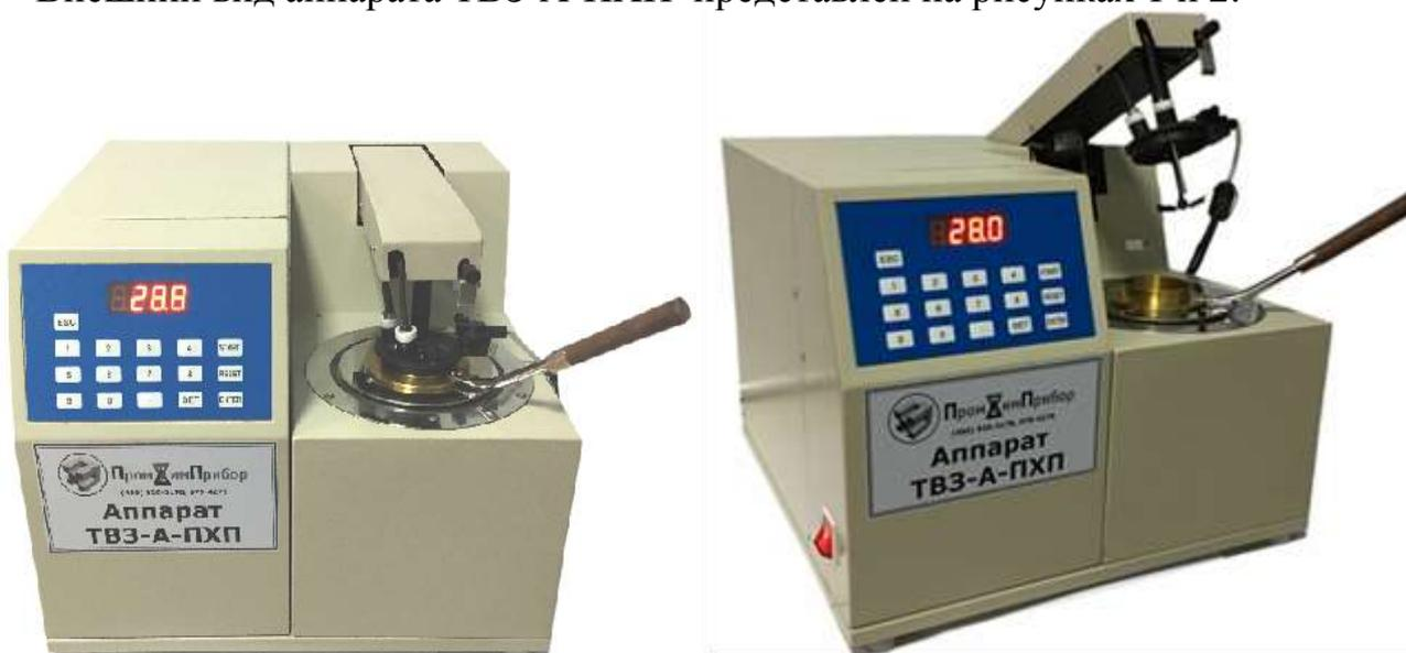
Рис. 1. Внешний вид аппарата ТВЗ-А-ПХП
