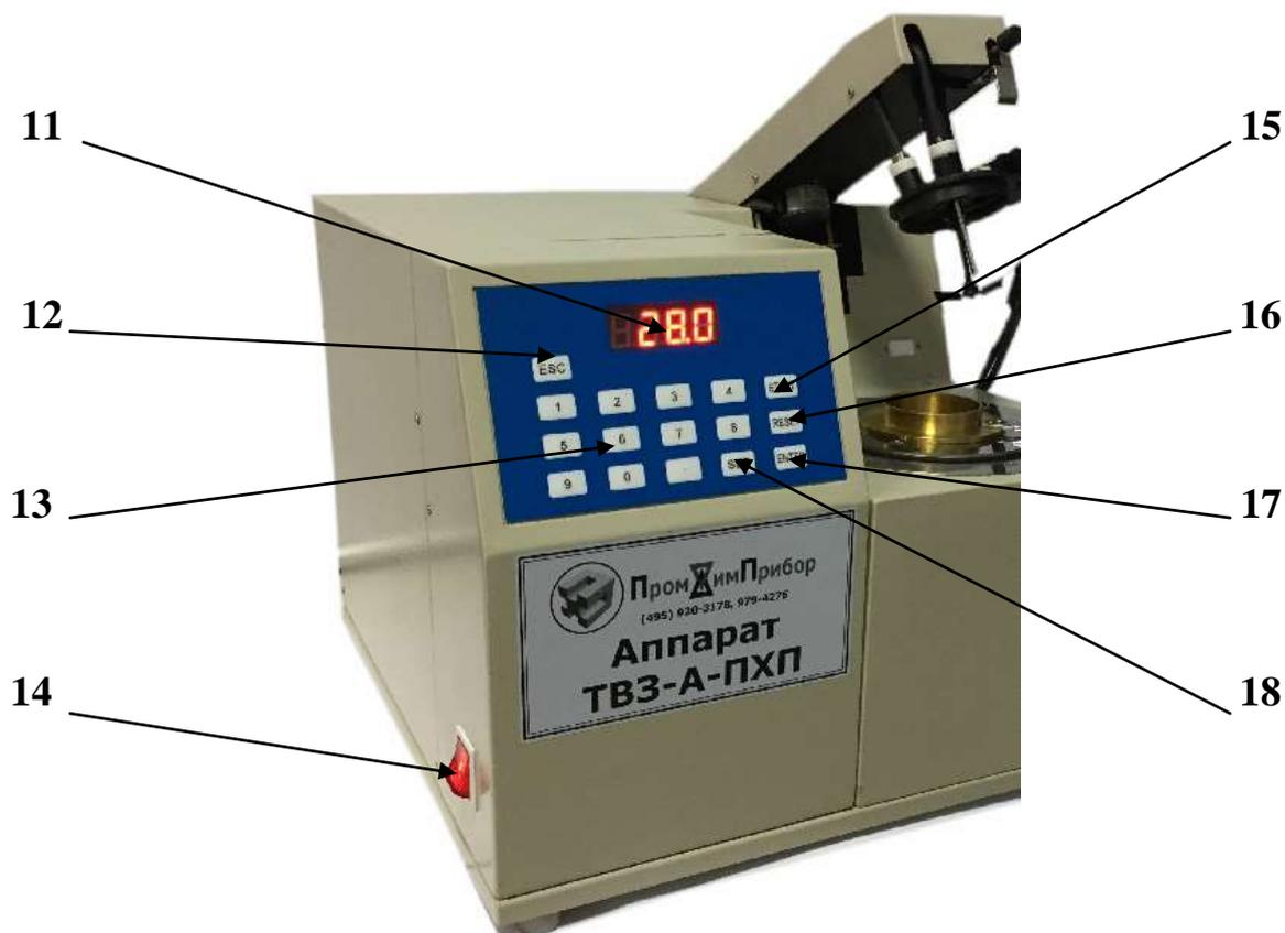
**Рис. 4. Устройство аппарата ТВЗ-А-ПХП
