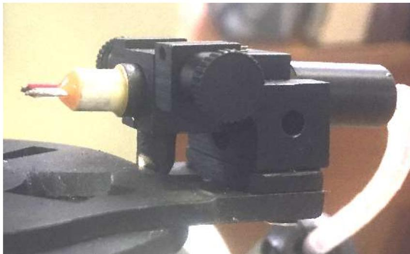
**Рис. 6. Электродуговой воспламенитель закрепленный в аппарате**
