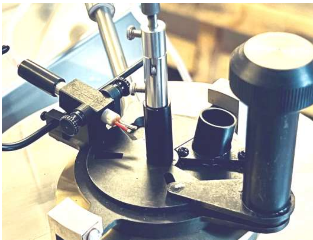
Рис. 6. Установка электрического воспламенителя в рабочее положение
