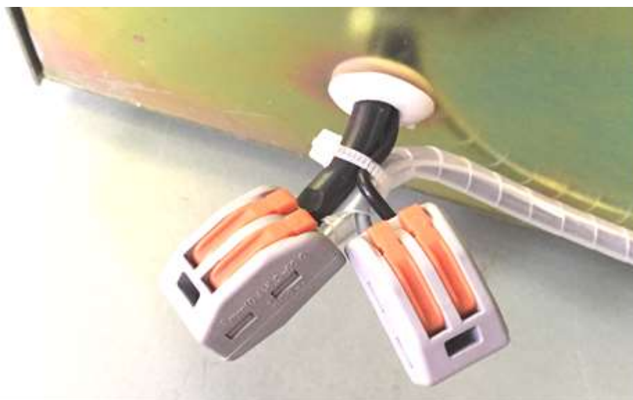
Рис.7. Клеммники с присоединенными контактами электрического воспламенителя на задней панели аппарата
