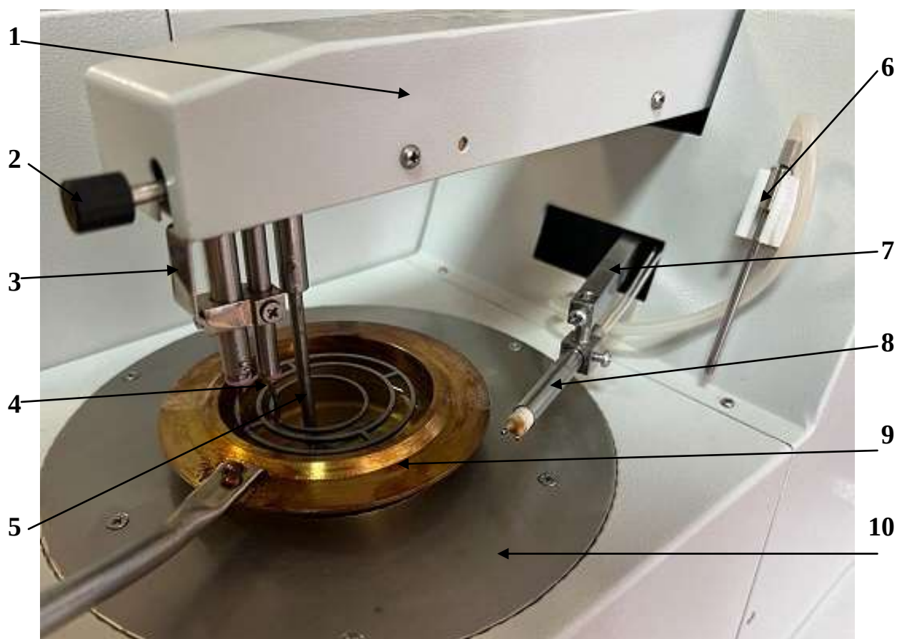
Рис. 3. Устройство аппарата ТВО-А-ПХП. Испытательный блок
