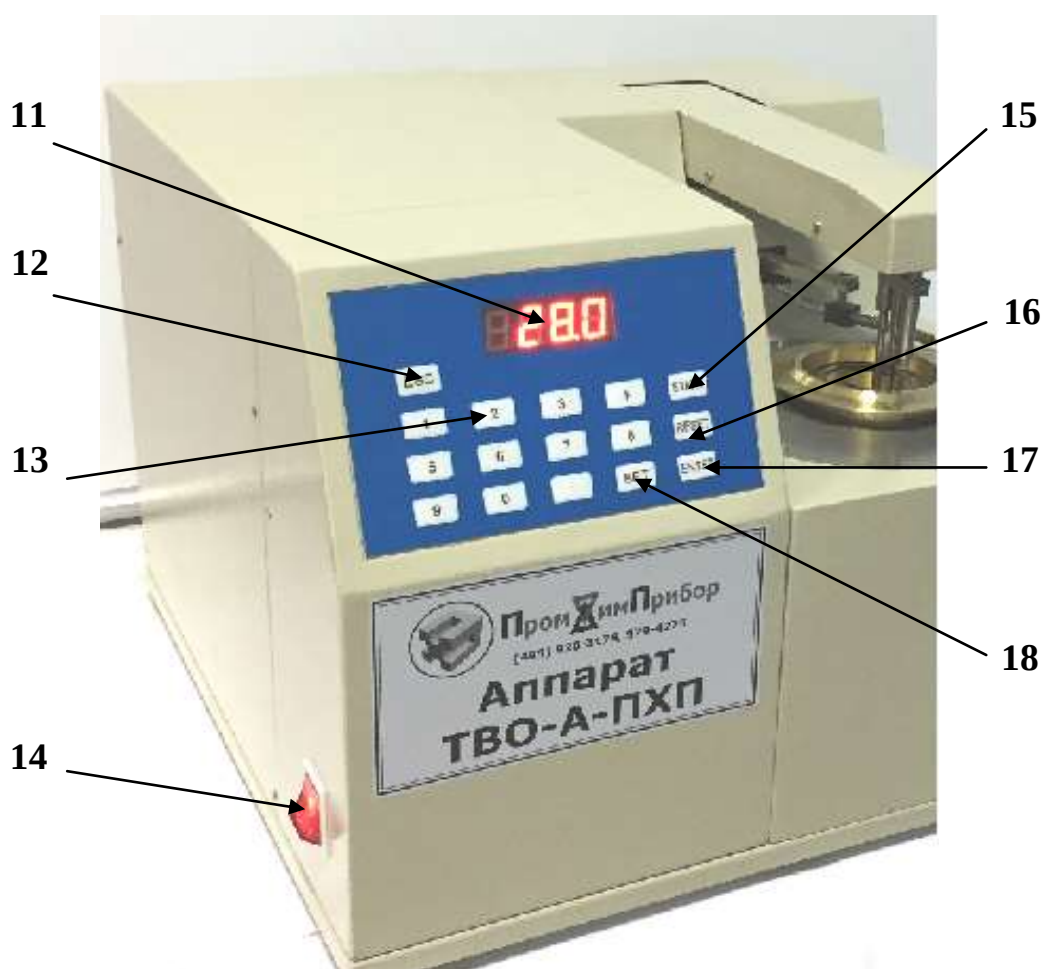
Рис. 4. Устройство аппарата ТВО-А-ПХП Блок управления с электронным дисплеем
