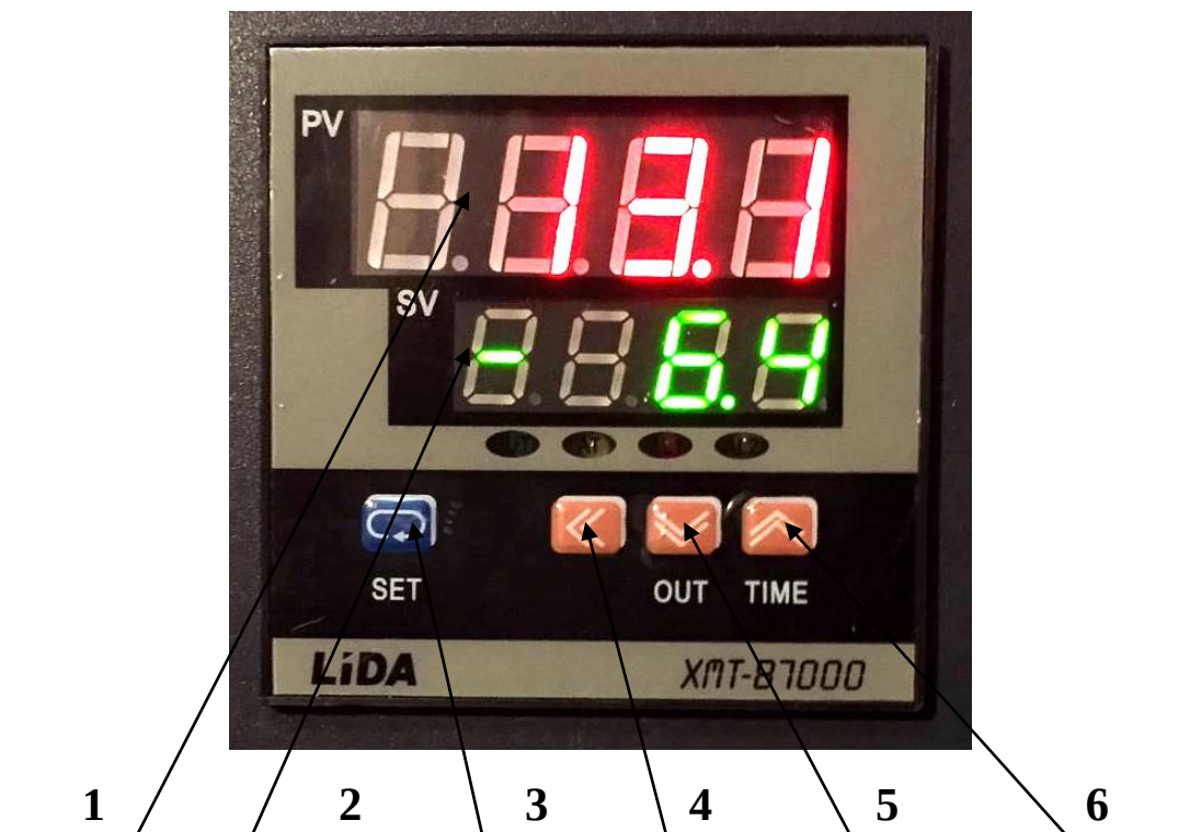
Рис. 3. Термоконтроллер аппарата АТЗ-70-ПХП
