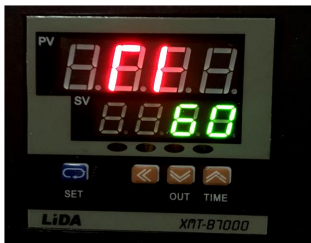
Рис. 5. Установка параметра термоконтроллера ГІ
