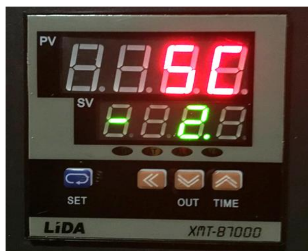
Рис. 4. Установка параметра термоконтроллера SC
