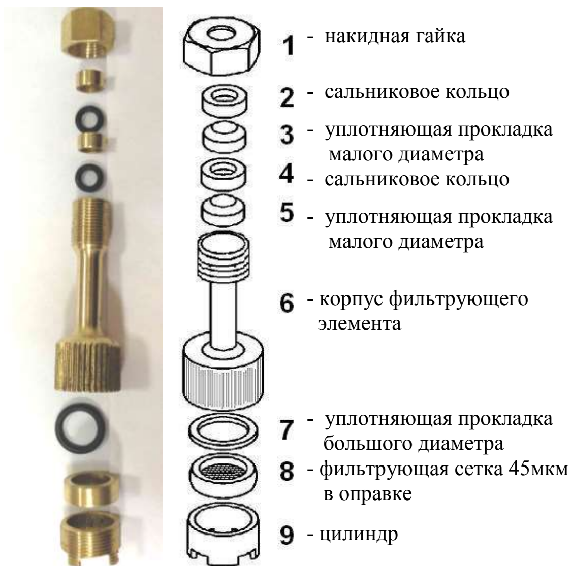
Рис. 11 Внешний вид и схема сборки фильтрующего элемента
