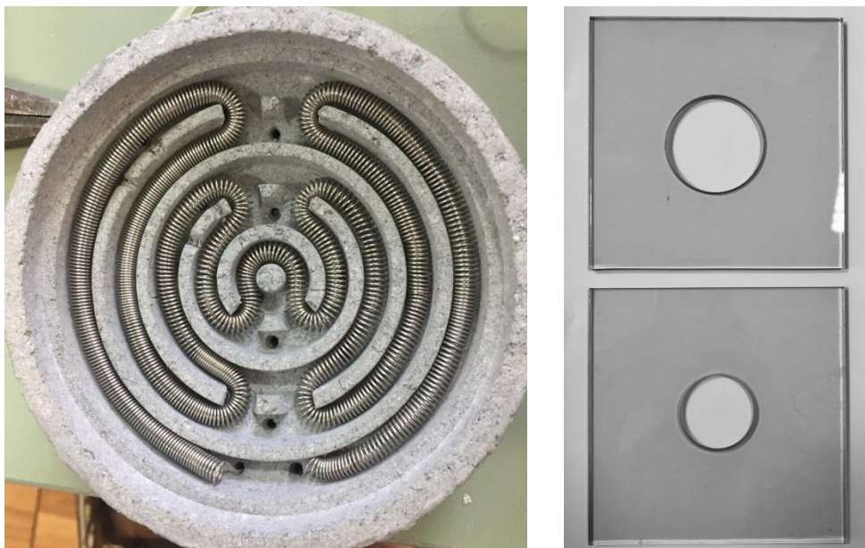
Рис. 3 а) и б). Электрический нагреватель с высокоомощной спиралью) и стеклокерамические подставки для разгона
