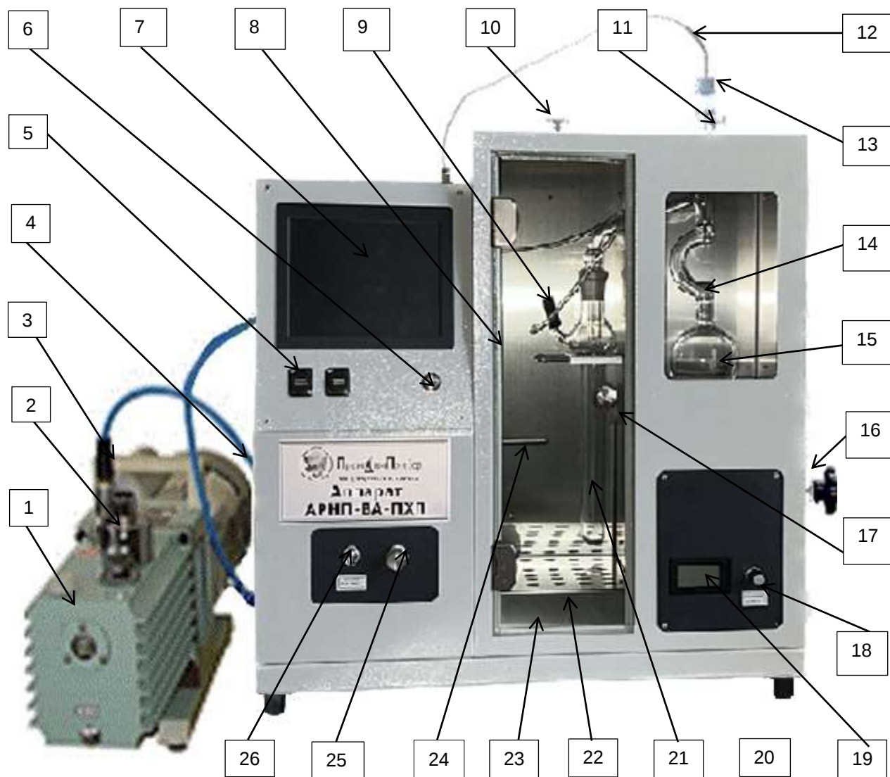
Рис. 5. Устройство аппарата АРНП-ВА-ПХП
