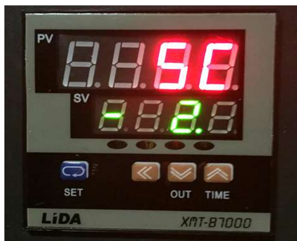
Рис. 4. Установка параметра термодатчика SC
